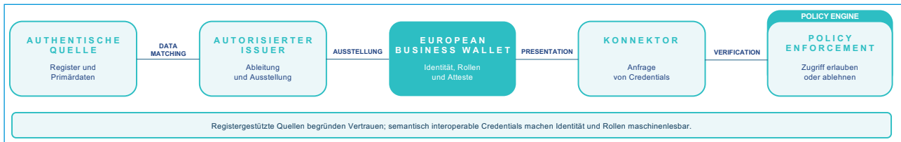
Abb. 1 EBW-Vertrauenskette im Datenökosystem – von der authentischen Quelle über autorisierte Issuer und EBW bis zur Prüfung im Konnektor und Regeldurchsetzung (Policy Enforcement) Quelle: eigene Darstellung
